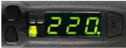
Die amperegenaue Einstellung des Schweißstroms und Jobauswahl sind feste Funktionen, zwei weitere LEDs können individuell mit weiteren Parametern vorbelegt werden.
