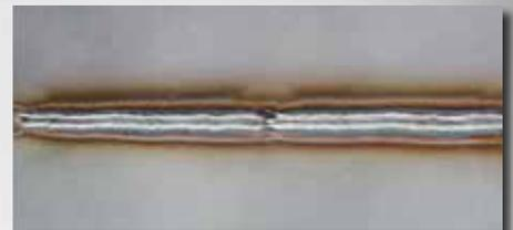
I-Naht, CrNi t= 0,8 mm, Luftspalt=0,8 mm
