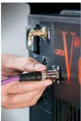
Lorchnet. Das alles verbindende Kabel, sowohl beim manuellen Schweißen als Verbindung zu Ihrer Lorchnet-Stromquelle. Und beim automatisierten Schweißen, als Verbindung zur LorchnetControl, der zentralen Steuerungseinheit der Lorchnet Automatisierung. Ihr Vorteil: Maximale Zuverlässigkeit und eine extrem schnelle Inbetriebnahme. Einfach Plug & Weld.
