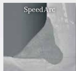
Beim SpeedArc ist der Einbrand in das Grundmaterial deutlich besser als bei normalen MIG-MAG-Anlagen.
