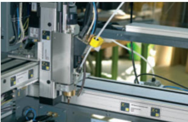
**Abb. links: Der hochleistungsgesteuerte Präzisionsschweißkopf KAH 412 erzielt beste Ergebnisse für alle Schweißverfahren.**
