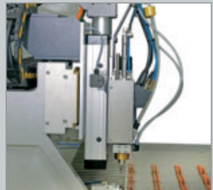
Oben: Fräskopf mit Absaugvorrichtung.
