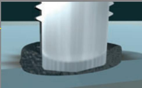
Das Ergebnis ist eine gleichmäßige Verbindung von sehr hoher Festigkeit, die über der des Grundwerkstoffes und des Bolzens liegt.
